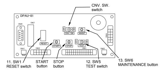
FIGURE 1.6 External I/F PCB IOAU-09
